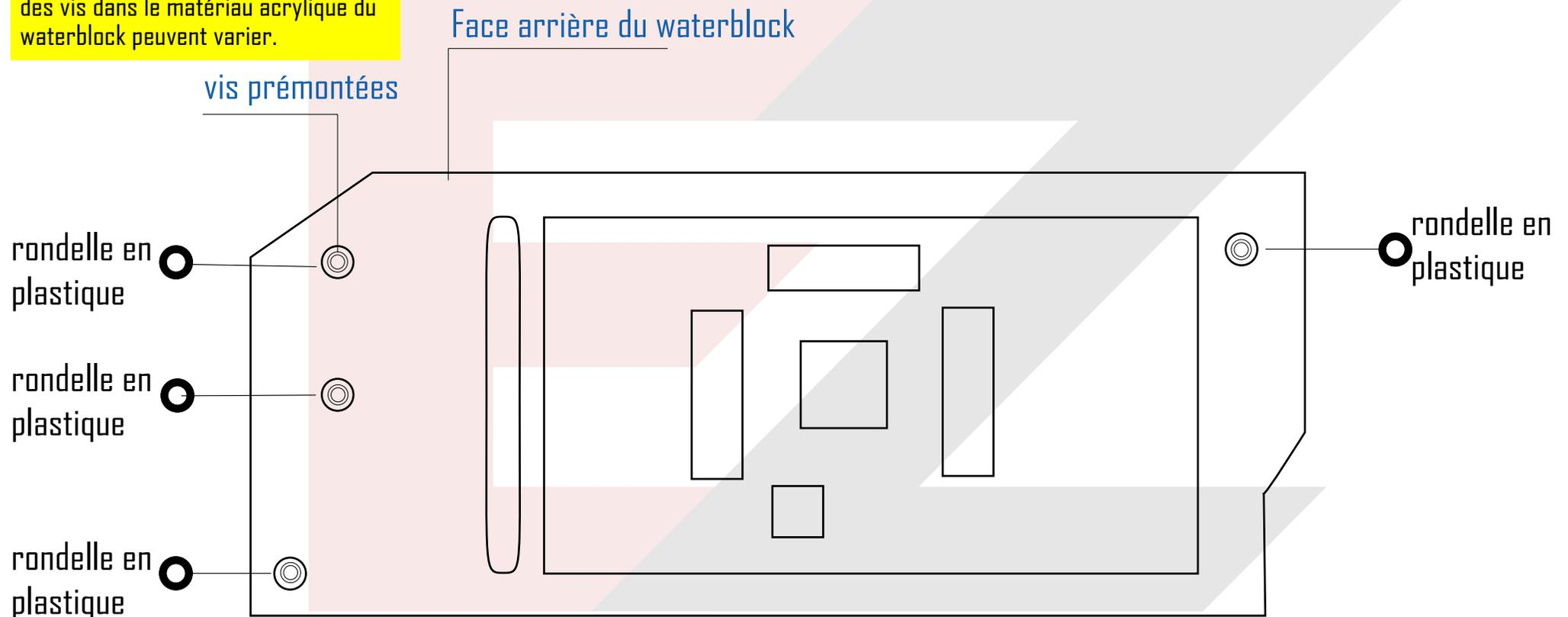
Les rondelles en plastique sont placées à l'arrière du waterblock sur les vis prémontées de la plaque acrylique du waterblock. Elles assurent une distance optimale entre le waterblock et la carte graphique et doivent coïncider avec les endroits marqués en orange (page 4 fig. 2) de la carte graphique.
